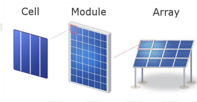
Şekil 2.1. PV panel ile PV hücre ilişkisi
