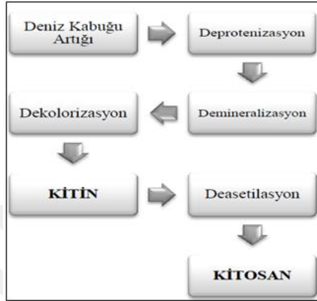
Şekil 1.2.b. Kitinden kitosan elde etme adımları (Üçgül ve ark., 2016)
