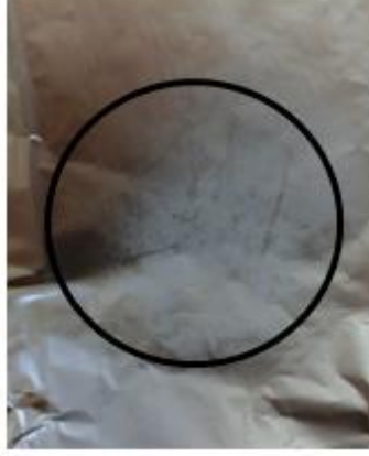
Şekil 4.36. %1.5 PEO-O üretiminde oluşan boşluklar
