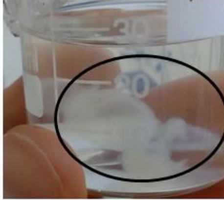
Şekil 4.38. PEO-D/CS:70/30-%1.5 tuzlu çözeltisinde karışmayan kitosan
