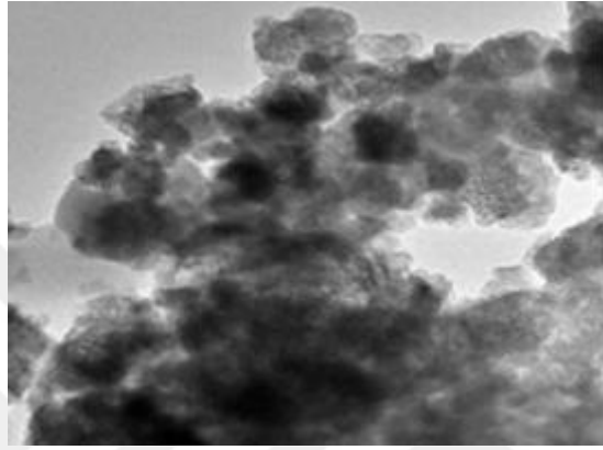
Şekil 1.3. TEM analiziyle kitosan nanopartiküller (Ayodele ve ark., 2018)
