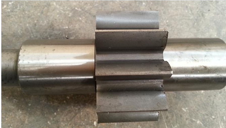
Şekil 3: Gerçek çalışma şartlarında aşınmaya maruz kalan hidrolik dişli pompa dişlisi.
