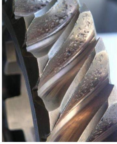
Şekil 48: Sonsuz dişlideki yorulma aşınması (URL-9, 2014).
