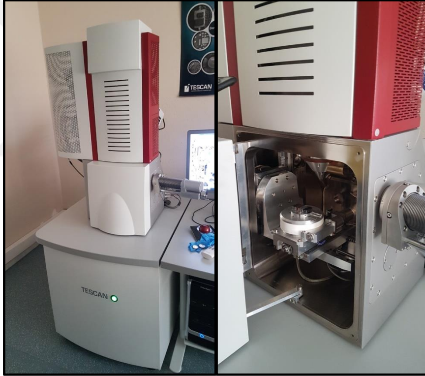
Şekil 6.1: Taramalı elektron mikroskobu (SEM).
