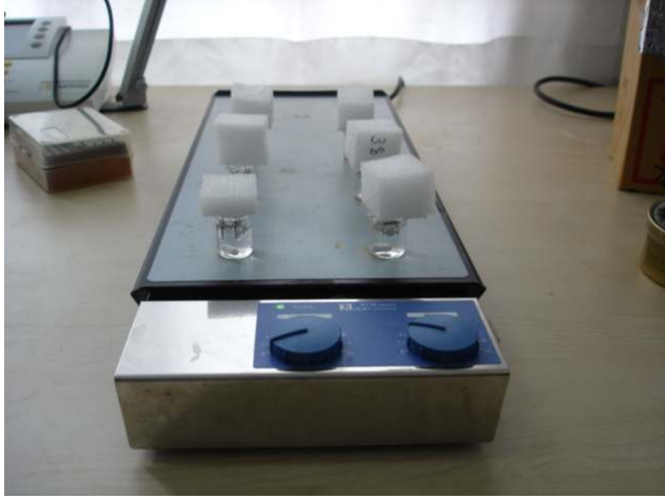
Şekil 3.6 Kuvars kristallerin manyetik karıştırıcıda çözelti ile etkileştirilmesi
