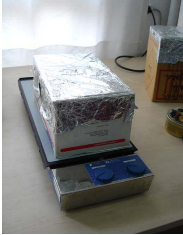
Şekil 3.8 Sistamin ve glutaraldehit immobilizasyonları için karanlık ortam eldesi
