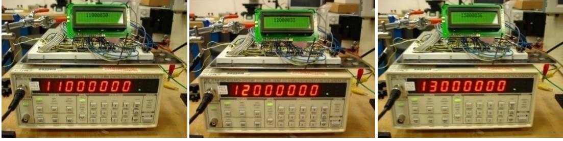
Şekil 3.3 Frekans sayıcı devresi ile sinyal jeneratörü validasyonu.
