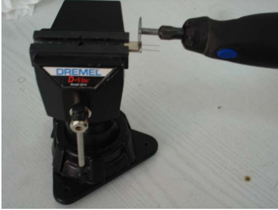
Şekil 3.4 Kuvars kristal metal kılıflarının kesici el aletiyle çıkarılması
