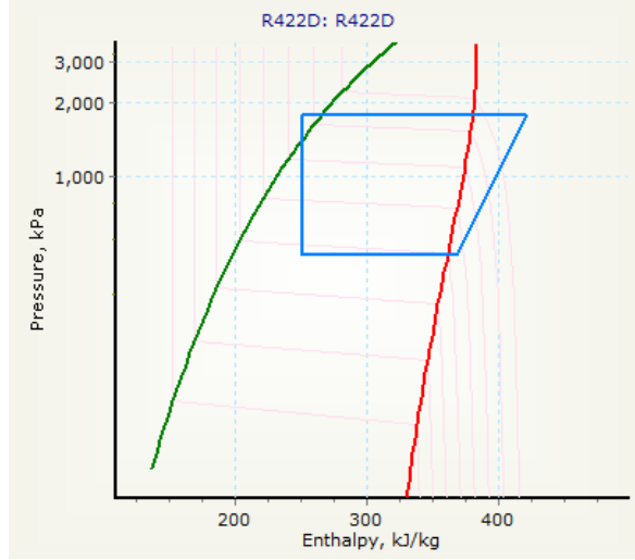
Şekil 4.1. T_c = 35^\circ\text{C} için basınç-entalpi diyagramı
