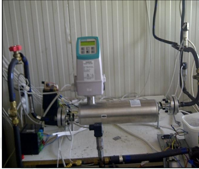
Şekil 3.3. Coriolis etki prensibine göre çalışan kütleli debi ölçer
