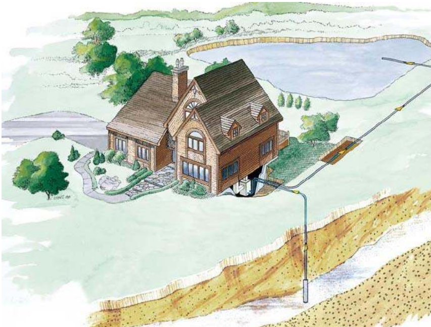
Şekil 3.6. Yer altı su kaynaklı ısı pompası uygulaması.
