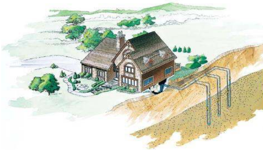
Şekil 3.8. Düşey tip TKIP pompasının uygulaması
