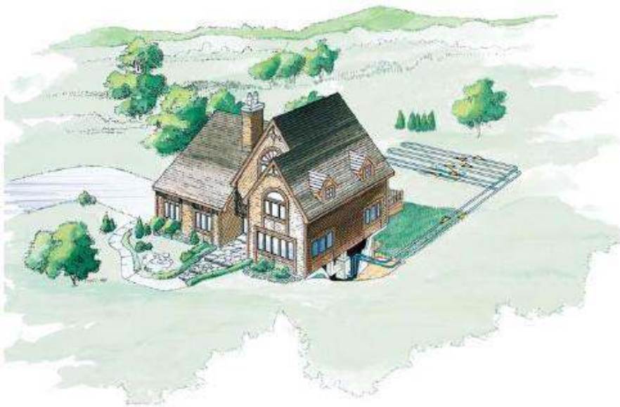
Şekil 3.7. Yatay tip TKIP pompasının uygulaması
