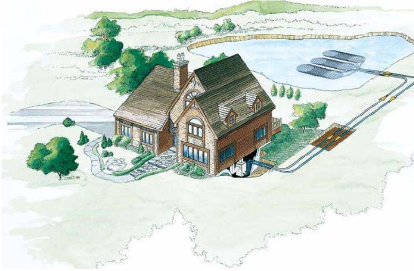
Şekil 3.5. Yer üstü su kaynaklı ısı pompası uygulaması.
