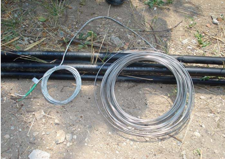
Resim 4.5. Toprak altı sıcaklığını ölçmek için kullanılan termokupl
