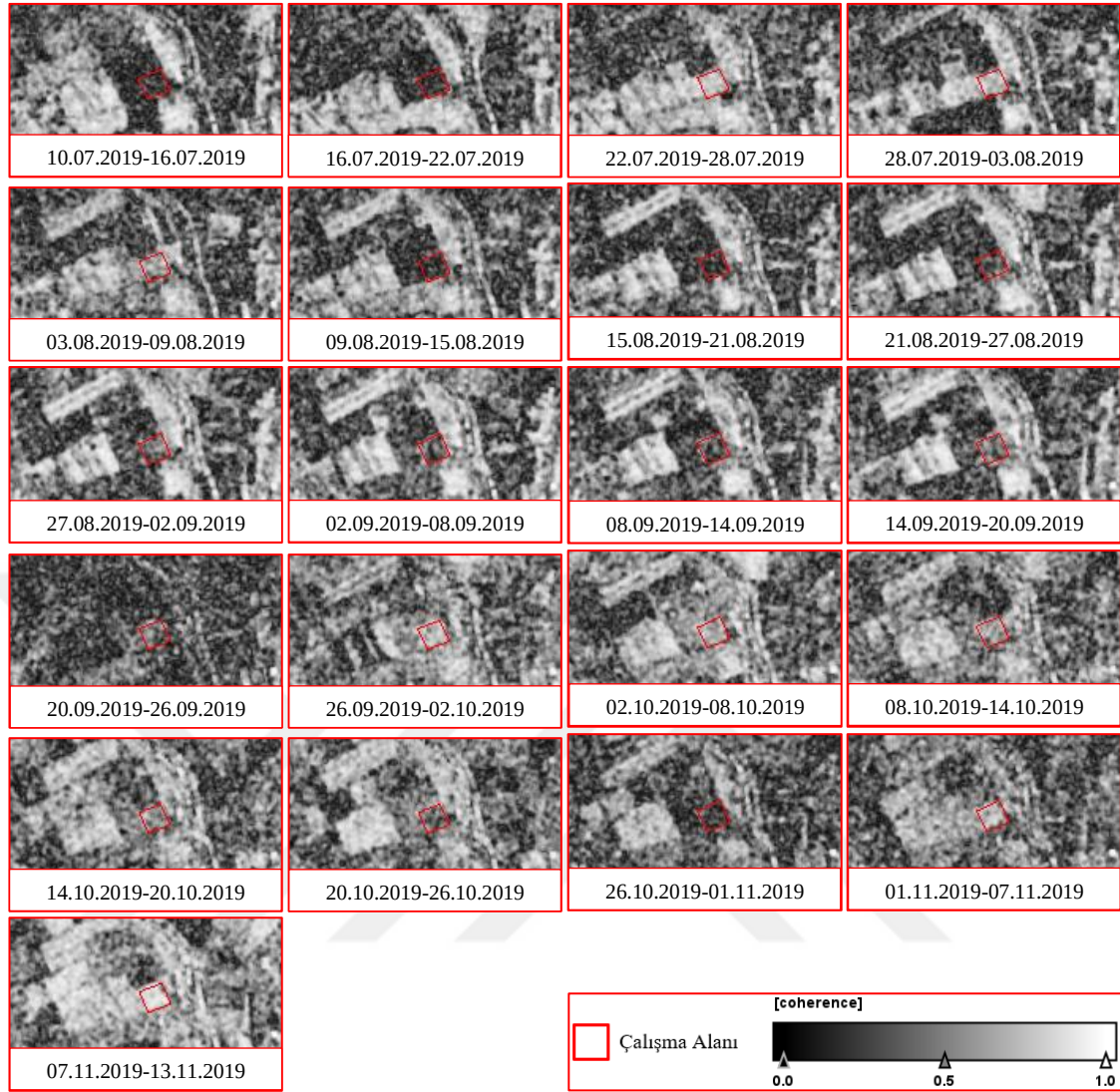
Şekil 4.18. Yükselen-160 yörüngesinden elde edilen Sentinel-1 uydu görüntü çiftlerinin VV polarizasyonu kullanılarak türetilen interferometrik uyumluluk görüntüleri
