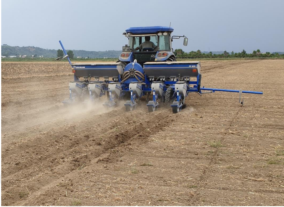
Şekil 3.3. 6 sıralı pnömatik hassas ekim makinesi ile mısır tohumlarının ekim işlemi
