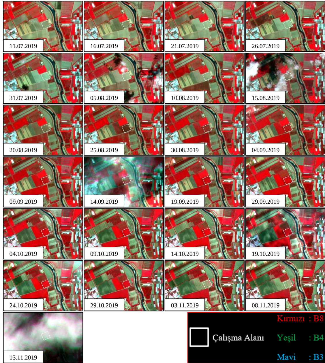
Şekil 4.28. Çalışmada kullanılan Sentinel-2 uydu görüntülerinin yalancı renk kombinasyonları
