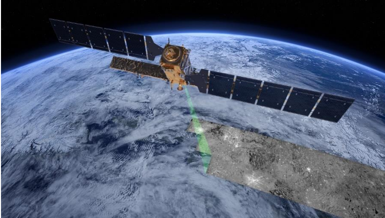
Şekil 3.12. Sentinel-1 uydusunun TOPSAR tekniğini kullanarak IW modunda görüntü elde etmesi (ESA 2014c)
