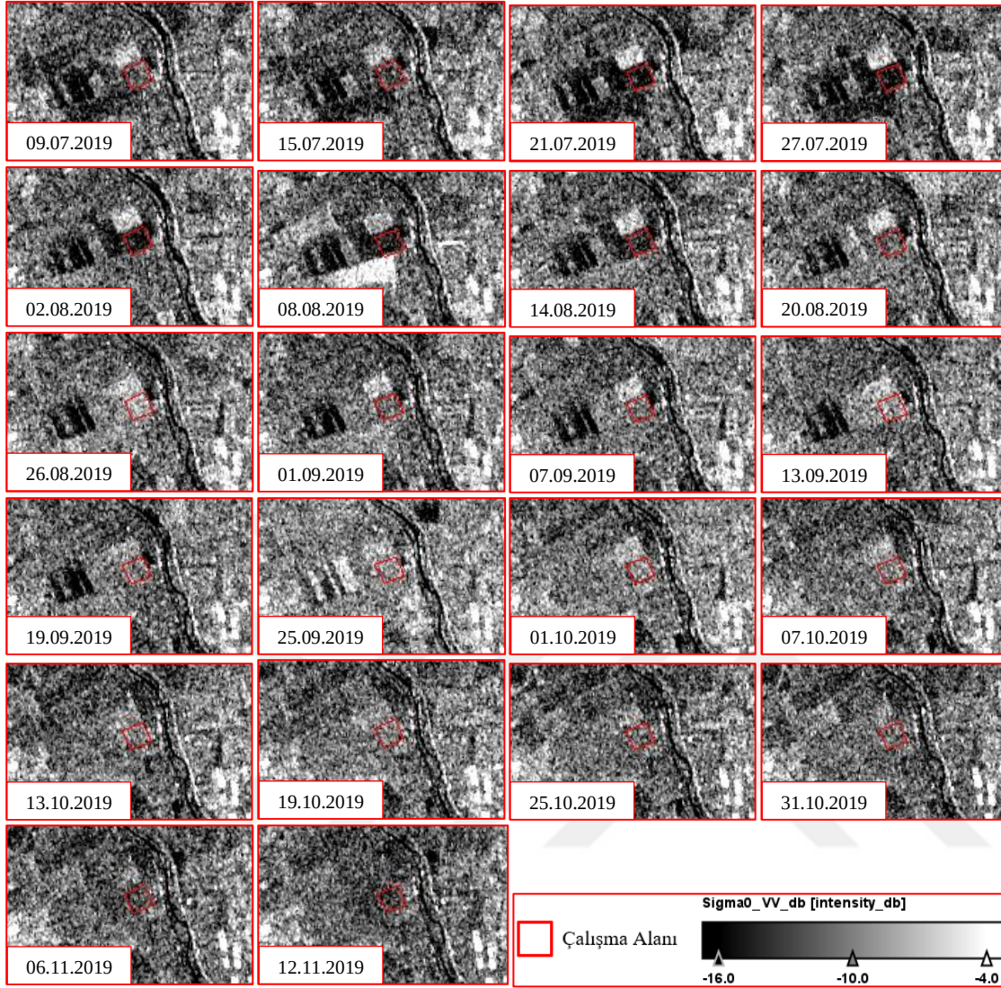
Şekil 4.4. Yükselen-58 yörüngesinden elde edilen Sentinel-1 uydu görüntülerinin VV bandına ilişkin görüntüleri
