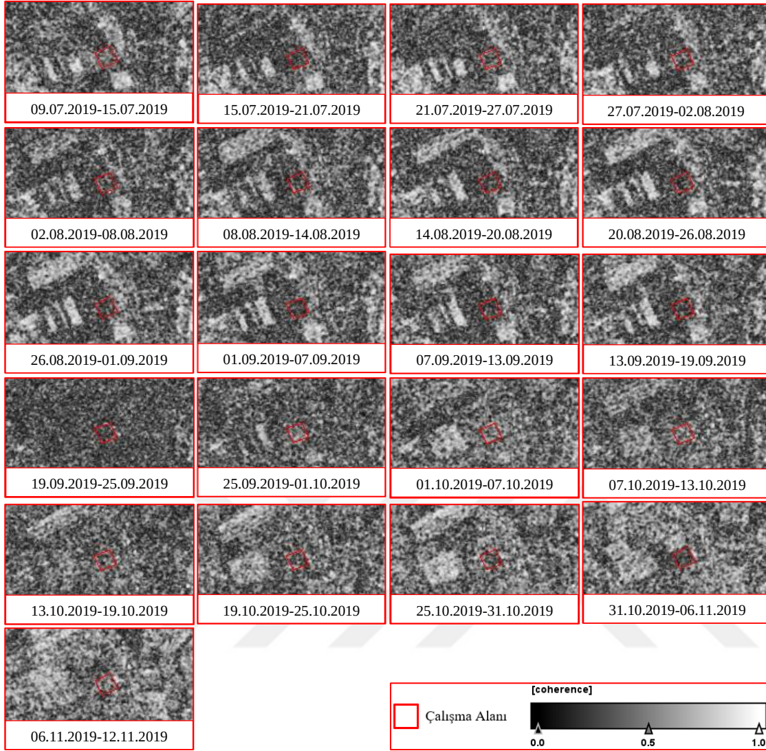
Şekil 4.17. Yükselen-58 yörüngesinden elde edilen Sentinel-1 uydu görüntü çiftlerinin VH polarizasyonu kullanılarak türetilen interferometrik uyumluluk görüntüleri
