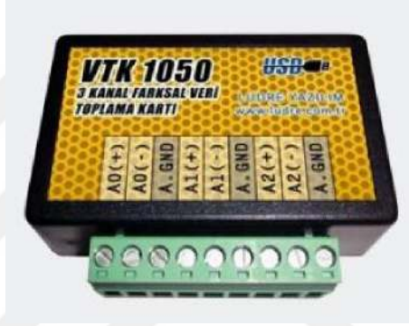
Şekil 3.4. VTK 1050 dijital- analog çevirici
