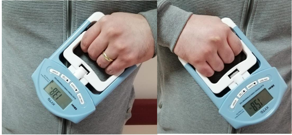
Şekil 29: Her iki elin kavrama kuvvetinin ölçümünde kullanılan elektronik el dinamometresi.
