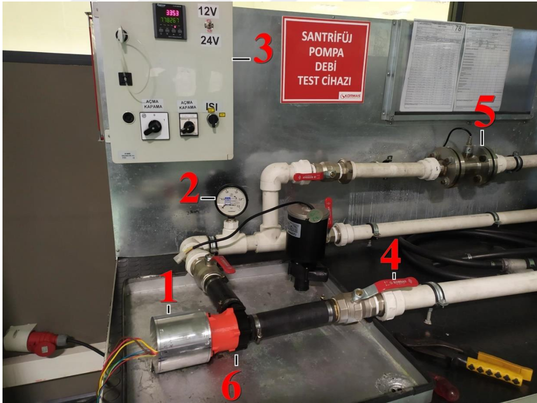
Şekil 5. 15. Pompa testi aşaması
