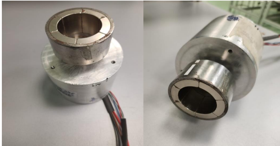
Şekil 5. 4. Test aşaması için hazır hale getirilmiş 6 kutuplu manyetik kavrama parçası
