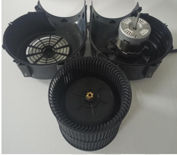
Resim 6.3. Salyangoz, motor ve pervane gruplama
