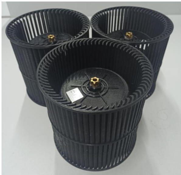
Resim 6.2. Üç boyutlu yazıcı kullanılarak üretilen farklı kanat geometrisindeki pervaneler
