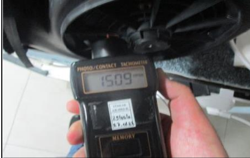
Resim 6.4. Manuel devir ölçüm yöntemi
