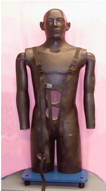
Şekil 2.7. EVA giysileri içindeki astronotları simüle etmek için kullanılan phantom (Moyers vd. 2006)
