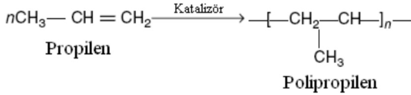
Şekil 3.2. Propilenin polimerizasyon denklemi
