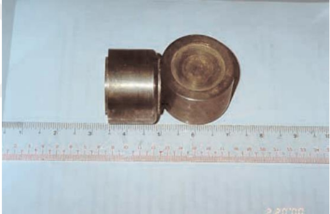
Şekil 4.17. Kaynak düzeneğinden silindirik parçalar (soldaki ögenin içi boştur; daha önce 60Co kaynağını çevreledi) (IAEA 2002)
