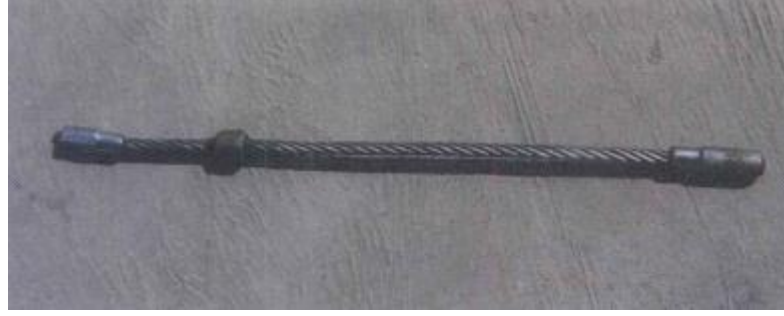
Şekil 4.15. Kaynakçının bulduğu radyasyon çubuğu (IAEA 2000)
