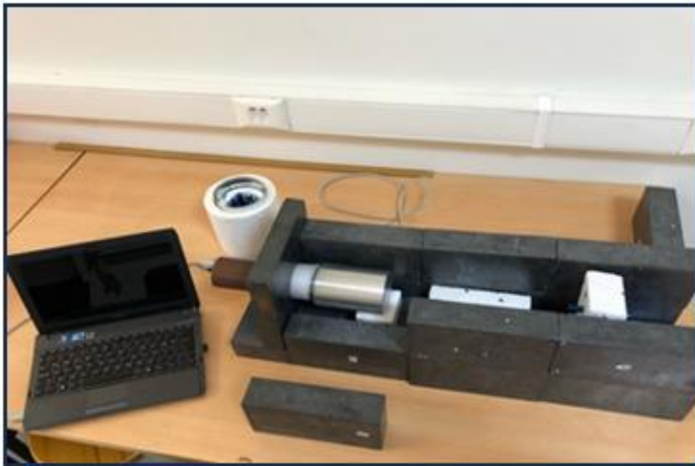
Şekil 3.15. Kaynak-dedektör sistemi, deneysel kurulumu
