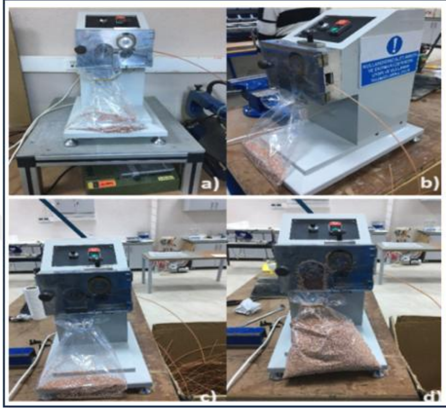
Şekil 5.4. Liflerin kırma makinası ile granül hale getirilmesi
