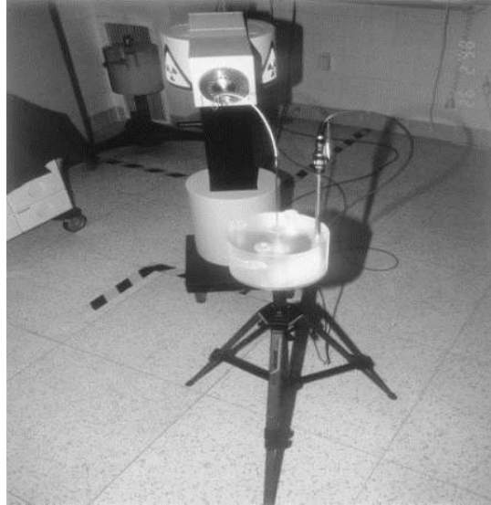
Fotoğraf 2.3. Mikroelektron HDR postşarjı ( ^{192}\text{Ir} kaynağı ile kalibre edilen PMMA tüp şeklindeki Krieger fantomu gösterilmektedir.)
