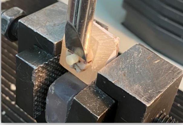
Resim 9. Kırma aparatının ucu, kompozit rezin örneklerine dik açıyla temas edecek şekilde yerleştirilmesi
