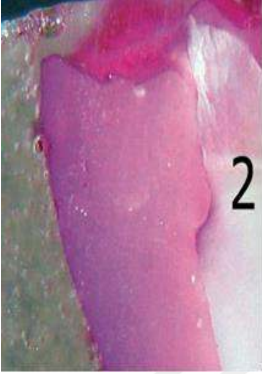
Resim 13. Radyasyon deney grubundan Filtek Z250'a ait okluzal kenarda 2 skoru alan sızıntı görüntüsü.
