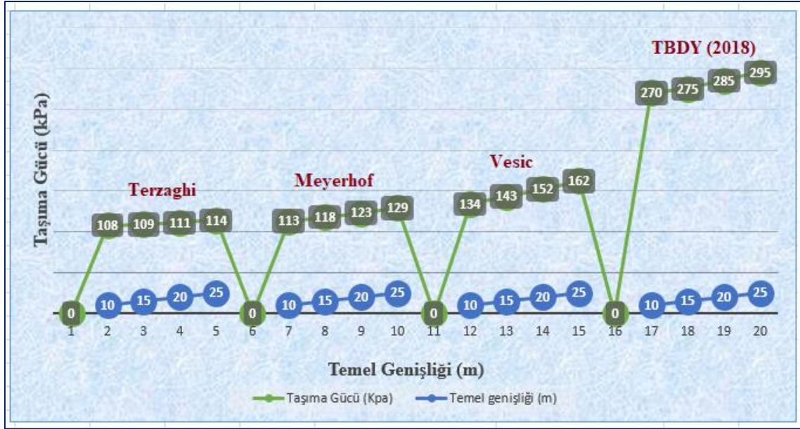
Şekil 4.53. I.Radye temel modeli analitik yöntemler ile hesaplanan taşıma gücü değerleri grafiği
