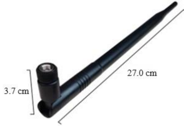
Şekil 6.3. Çalışmada kullanılan anten (URL-5).
