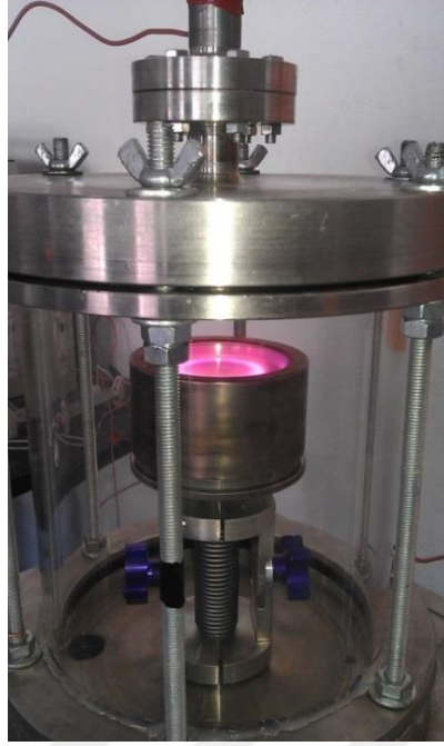
Şekil 4.4 RF manyetik saçtırma sisteminin vakum odası.
