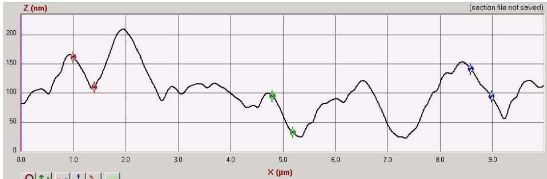
Şekil 4.51 150 W sistem gücü 30 dk. kaplama süresinde elde edilen TiN 7.3. ince filmin histogram ve pürüzlülük AFM görüntüleri.
