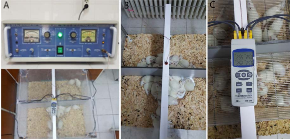
Şekil 3.2. Sıçanlar 95x95x40 cm boyutunda dört bölmeli uygulama kafesine konup, RF jeneratörü 1800 MHz ve 1 Watt çıkış gücünde çalıştırıldı (A). RF-EMR. Uygulanması sırasında sıçanlar antene yakın bölgede kümelenme gözlenmiştir (B). Maruziyet sonrası kafesin dört köşesinden yapılan sıcaklık ölçümlerinde anlamlı bir fark gözlenmemiştir (C).
