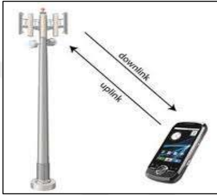
Şekil 9. Cep Telefonlarında Uplink ve Downlink bağlantı (59).
