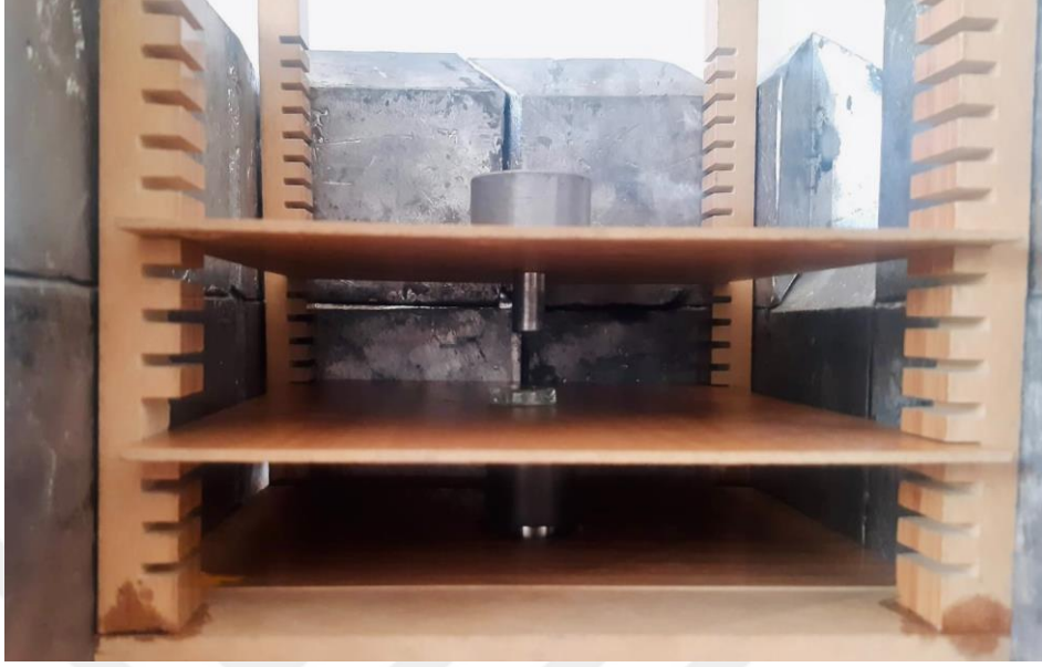
Şekil 3. 9: Ba-133 radyoizotop kaynağı ile 80.998 keV, 160.612 keV, 223.237 keV, 276.399 keV, 302.851 keV, 356.013 keV ve 383.849 keV enerji değerlerine karşılık \mu/\rho ( \text{cm}^2/\text{g} ) ölçümünün gerçekleştirildiği deney düzeneği.
