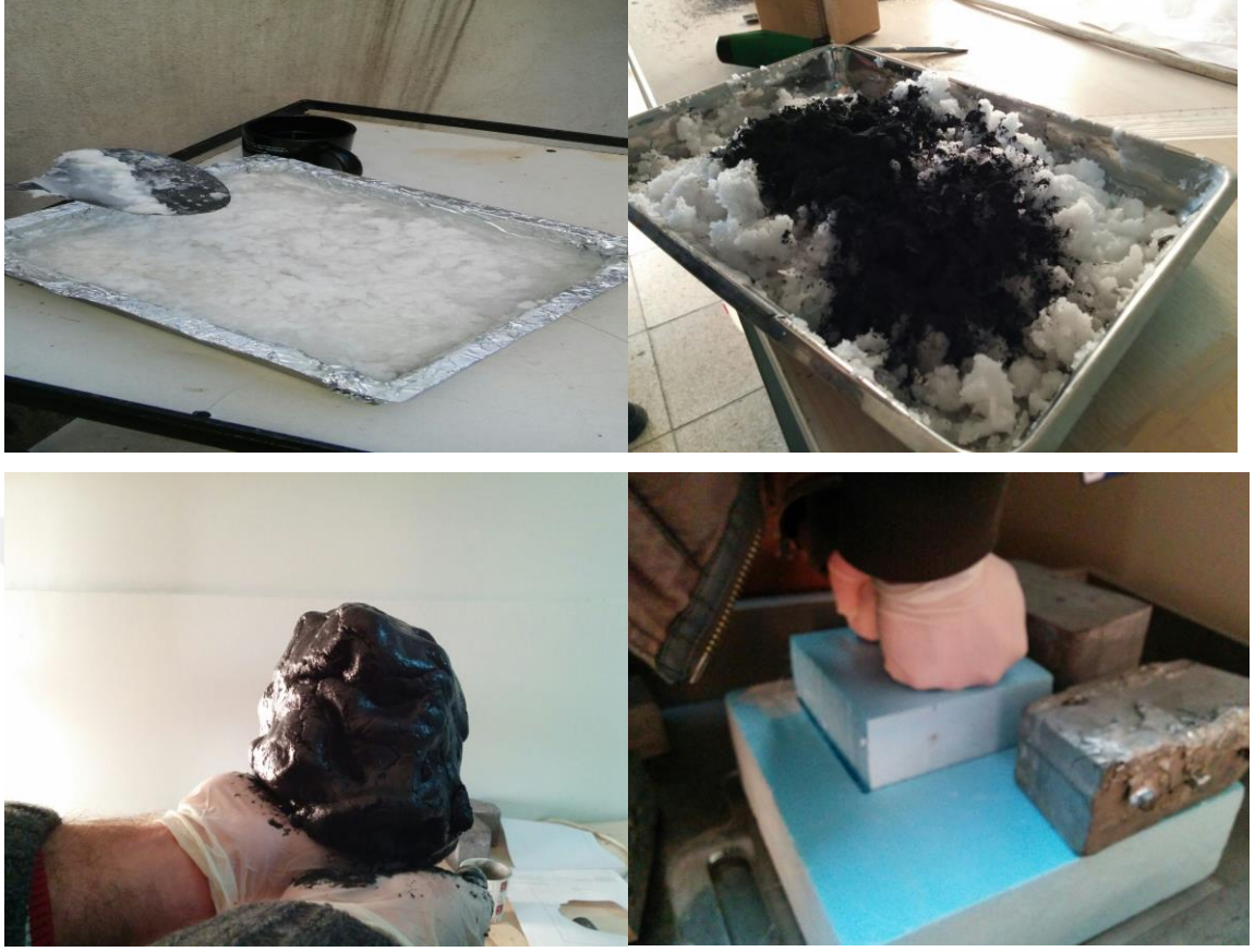
Şekil 3.9. B 4 C katkılı parafinin yapım aşamaları
