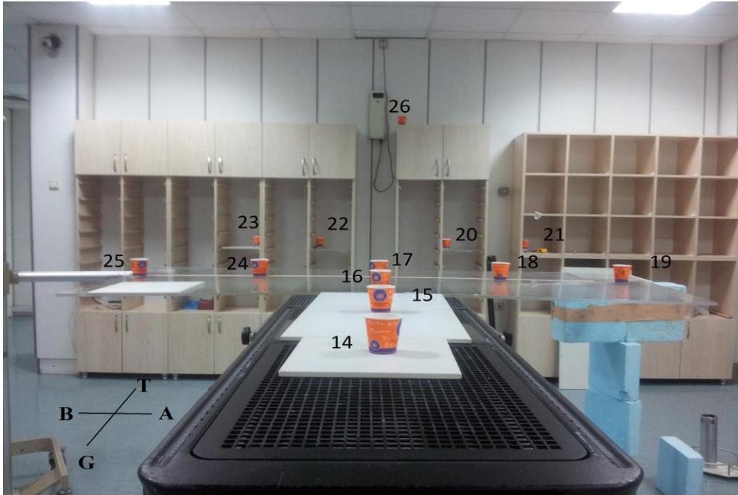
Şekil 4.5. Lineer hızlandırıcı odasındaki fotonötron akı tayini için içerisinde indiyum ve kadmiyum yaprakları bulunan bardakların konumu (Deney düzeneği II, #14 bardak SSD=100 cm'de, 100 cm T yönünde)
