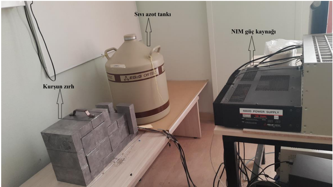
Şekil 3.15. Deneylerde kullanılan Akdeniz Üniversitesi Nükleer Bilimler Uygulama ve Araştırma Merkezi'ne ait HPGe dedektörü (NIM güç kaynağı, sıvı azot tankı ve kurşun zırh)
