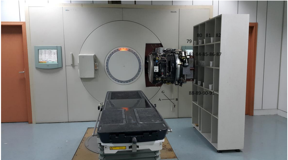
Şekil 4.29. Lineer hızlandırıcı odasındaki fotonötron akı tayini için içerisinde indiyum ve kadmiyum yaprakları bulunan bardakların konumu (Deney düzeneği VII)
