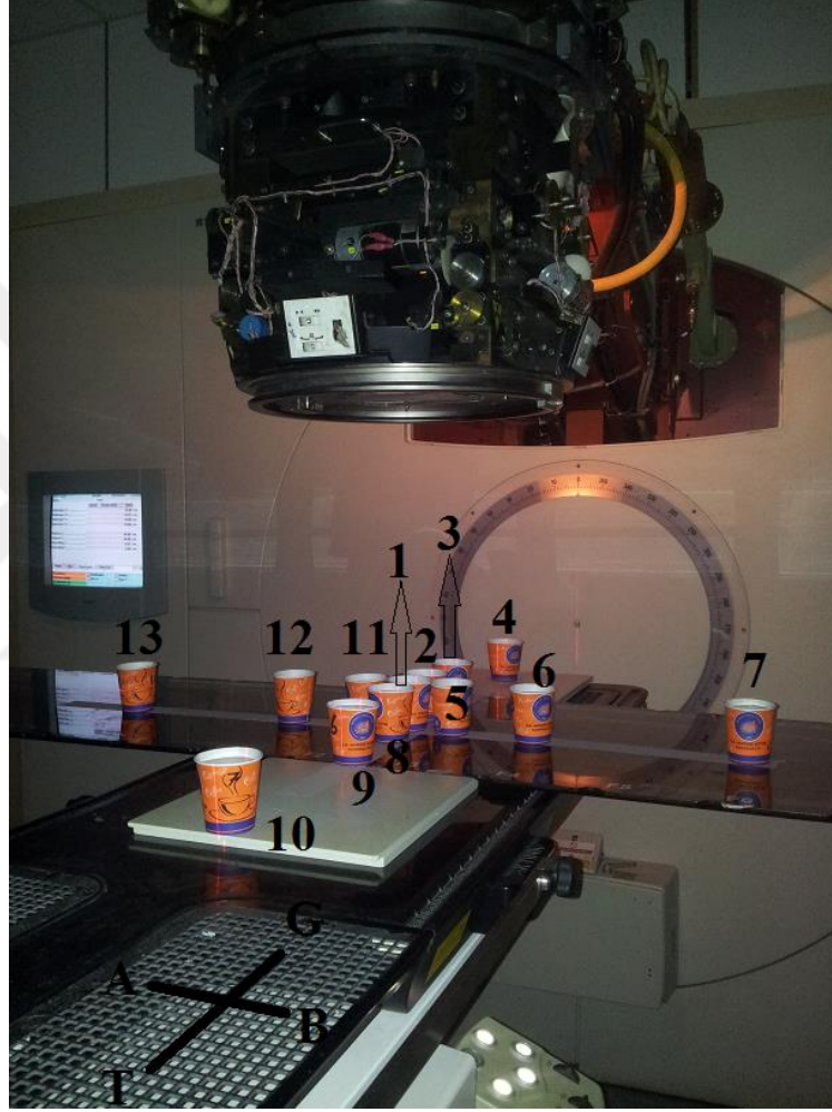
Şekil 4.1. Lineer hızlandırıcı odasındaki fotonötron akı tayini için içerisinde indiyum ve kadmiyum yaprakları bulunan bardakların konumu (Deney düzenegi I)
