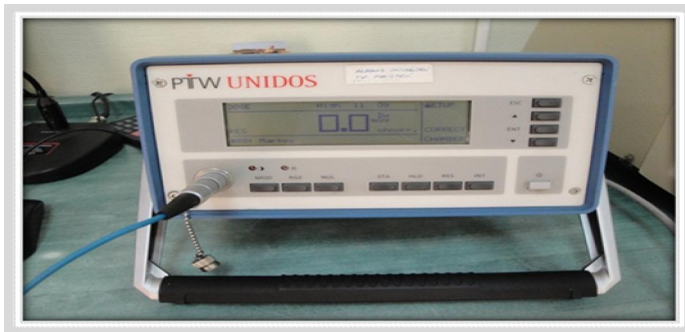
Şekil 3.9. PTW- Unidose dozimetre
