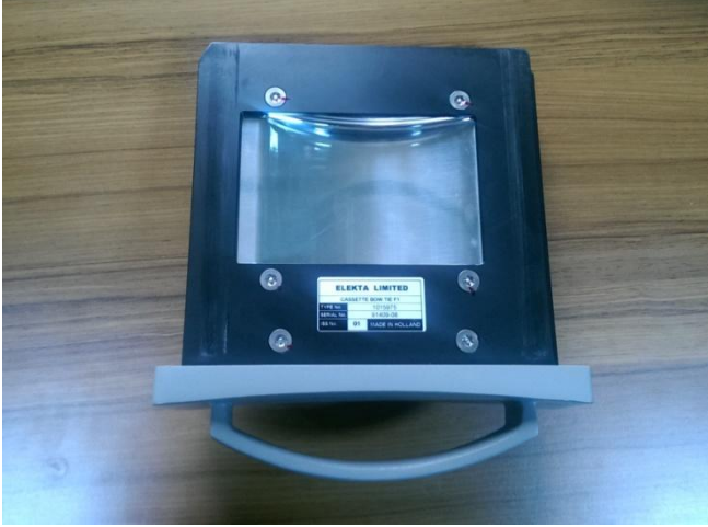
Şekil 3.6. XVI üç boyutlu görüntüleme cihazı, papyon filtre kaseti
