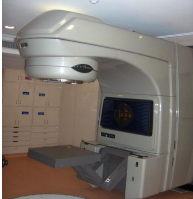
Şekil 1.3 Çoklu kolimatörlü bir lineer hızlandırıcı. (LİNAK-3)
