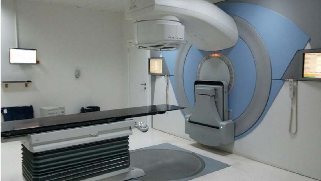
Şekil 3.1. Elekta Synergy Platform model Agility kafa lineer hızlandırıcı cihazı.
