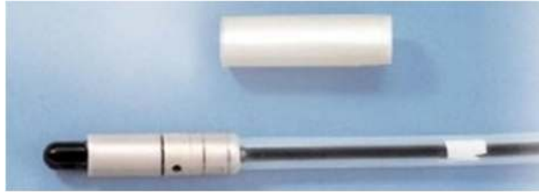
Şekil 3.2. CC13 kompakt iyon odası.
