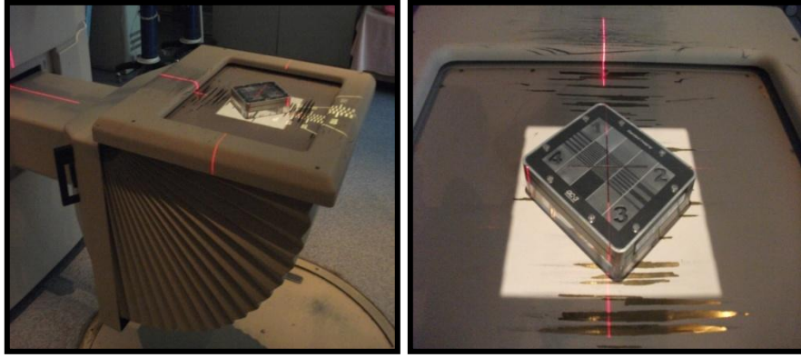
Şekil 15: Fantomun EPG cihazının dedektör çerçevesi üzerine yerleştirildiği birinci set-up .
