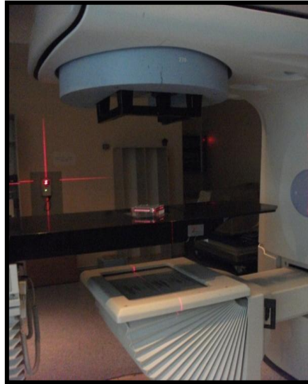
Şekil 16: Fantomun izosentira yerleştirildiği ikinci set-up .
