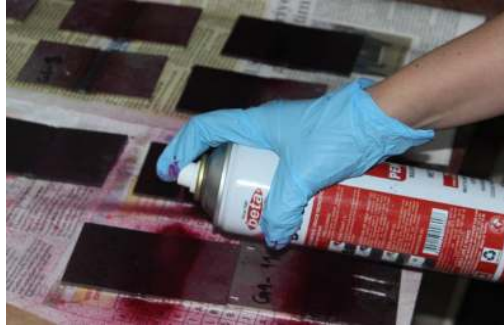
Şekil 34. Püskürtme yöntemi ile penetrant uygulanması.
