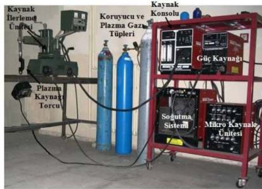
Şekil 29. Thermal Dynamic/Arc PTA kaynak makinesi koruyucu gaz tüp bağlantıları ve kontrol paneli
