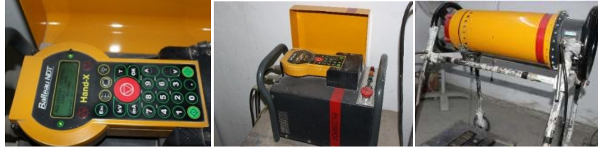
Şekil 31. Kontrol paneli, Güç kaynağı ve Işınım cihazı
