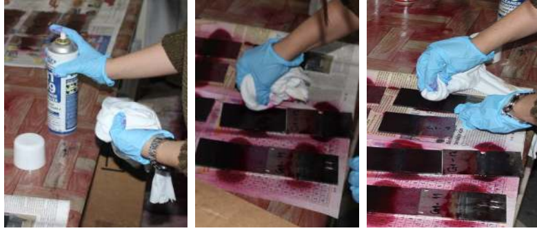
Şekil 35. Fazla penetrantın Cleiner ile yüzeyden uzaklaştırılması
