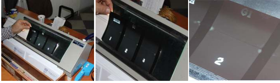
Şekil 33. Işık cihazında filmlerin incelenmesi.
