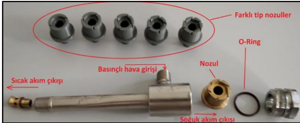
Şekil 5.3: Çalışmada kullanılan karşıt akışlı RHVT'nin görünümü
