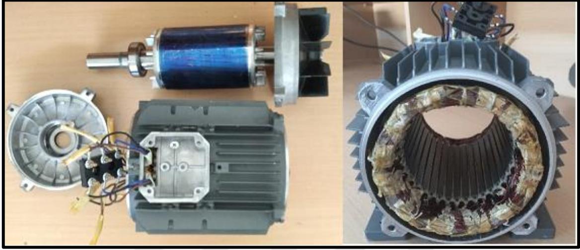
Şekil 5.2: Çalışmalarda kullanılan ÜFAM'ın demonte görünümü
