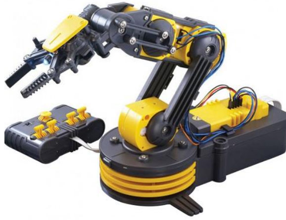
Şekil 5.6. OWI-535 robot kolu
