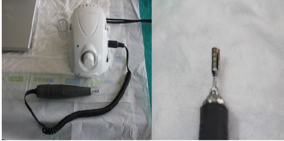
Resim 3.6: Kaviterin hazırlanmasında kullanılan motor ve 5mm çapında özel tasarlanmış trephayn frez
