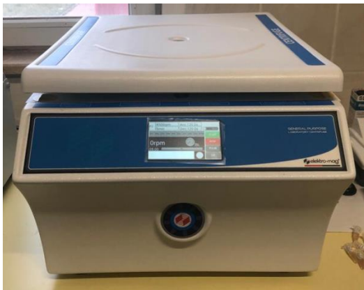
Resim 2.1: Elektromag M4808 P Genel Amalı Santrifüj cihazı
