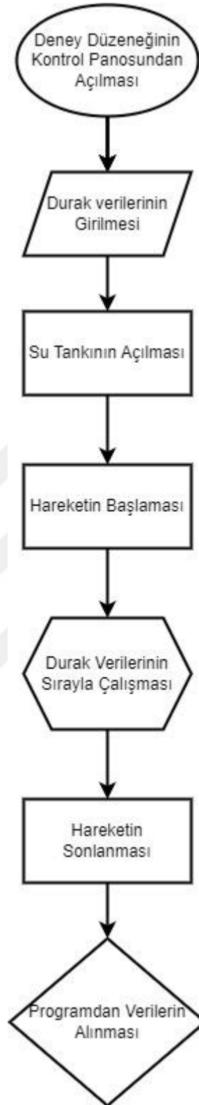
Şekil 4.35. OMÜ Yurtlar-Tekkeköy deney rotasının sulu şartta akış diyagramı
