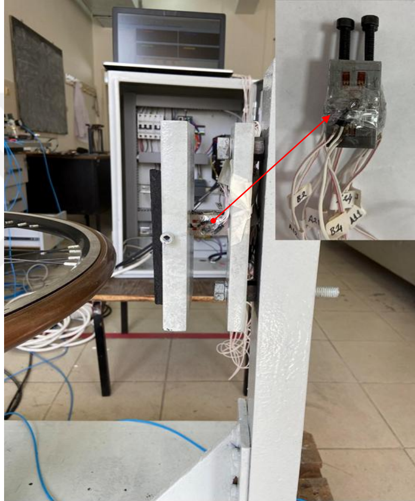
Şekil 4.25. Dinamometrenin deney düzeneğine montajlanmış görüntüsü
