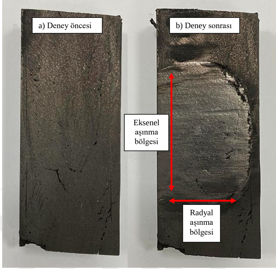
Şekil 5.36. Yerli üretim grafit plakanın kuru şartta aşınma deneyi öncesi (a) ve deney sonrası (b) yüzey görünümleri
