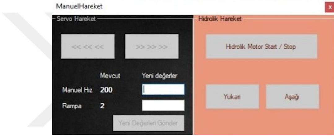
Şekil 4.15. Manuel ve hidrolik kontrol arayüzünün görüntüsü
