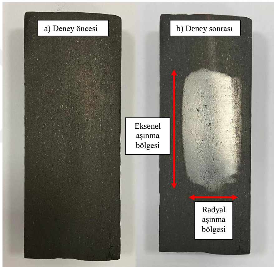
Şekil 5.34. Grafit plakanın kuru şartta aşınma deneyi öncesi (a) ve deney sonrası (b) yüzey görüntüleri
