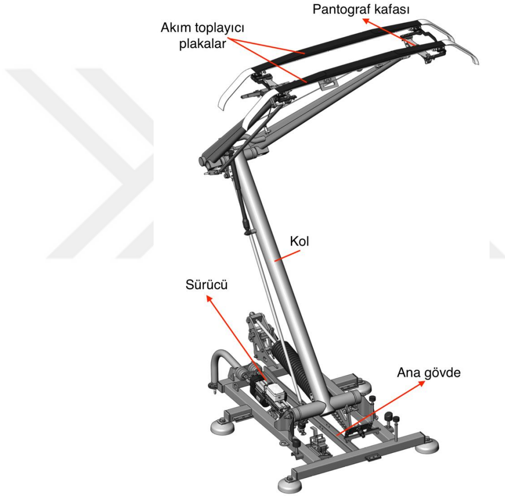
Şekil 3.16. Pantograf mekanizması ve bileşenleri (Stemmann teknik)
