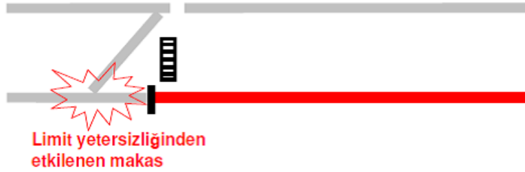
Şekil 3.8. Limit yetersizliğinden etkilenen makas
