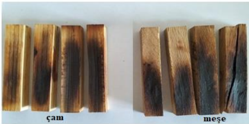
Şekil 3.5. Çam ve meşe ahşaplarının deney sonrası görünümü
