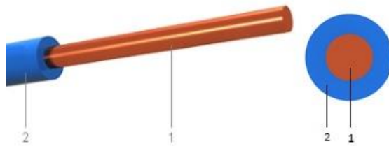
Şekil 5.2. 1,5 \text{ mm}^2 tek damarlı alçak gerilim kablo kesiti
