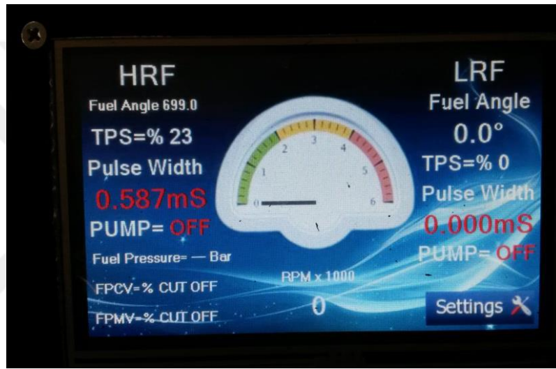
Şekil 2.6. HRF ve LRF sisteminin kontrol ünitesine ait arayüz
