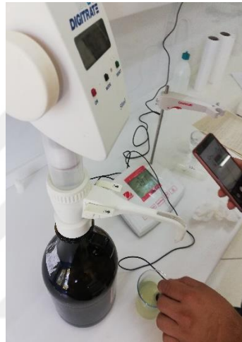
Şekil 3.7. Titrasyon asitliğinin belirlenmesi
