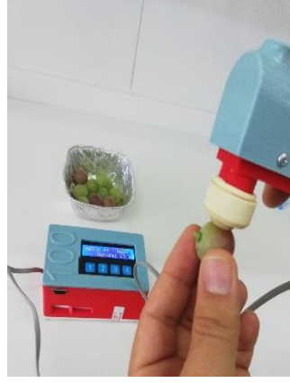
Şekil 3.4. Tane eti sertliğinin ölçülmesi
