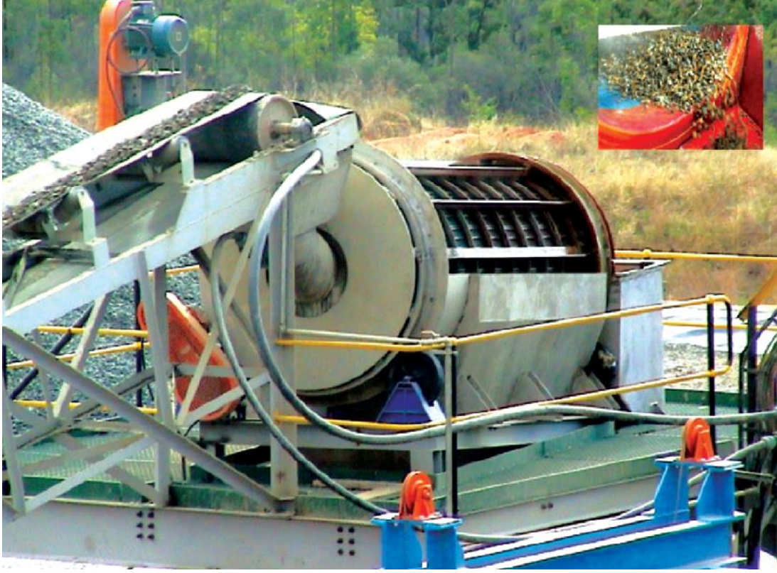
řekil 2.16: GEOCOAT prosesinde destek tařların tromel elek ile yıkanıp ayrılması (Harvey ve Bath, 2005).
