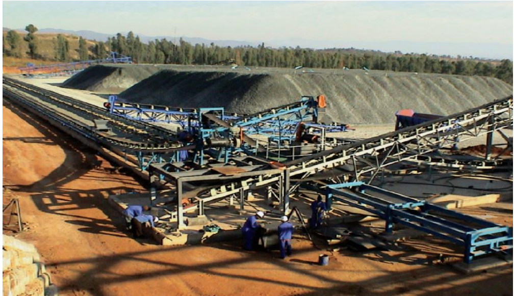
Şekil 2.15: GEOCOAT prosesini kullandığı Agnes altın madenin yığın liçi sahası (Harvey ve Bath, 2005).
