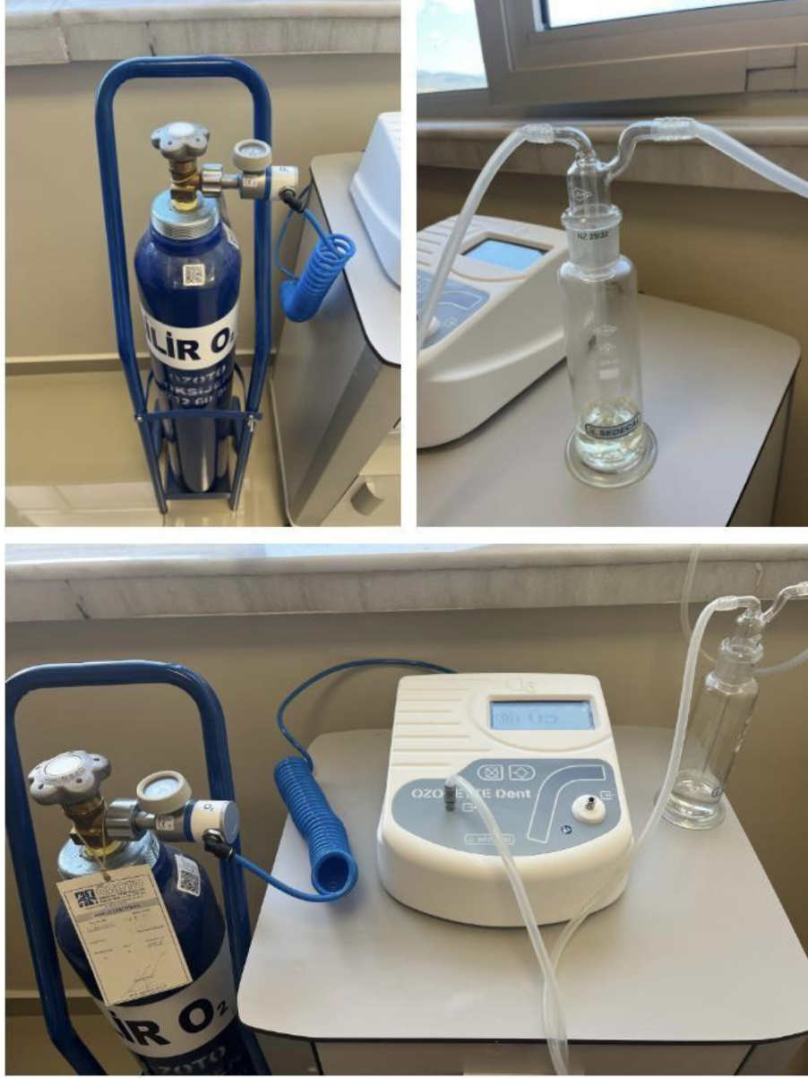
Şekil 3.4 Ozon cihazı ile EDTA'nın ozonlanması
