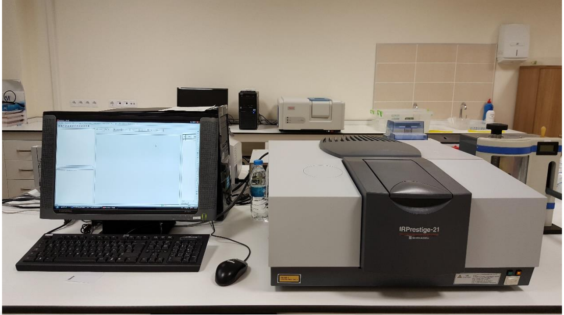
Şekil 4.26. Kullanılan FTIR'ın görseli
