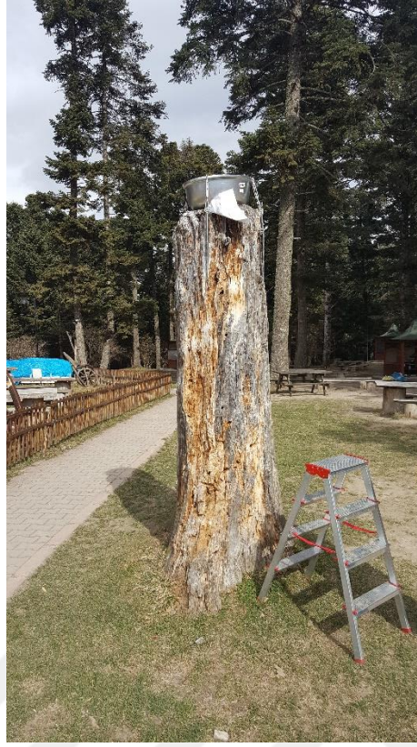
Şekil 4.37. Atmosferik toplam çökelme örnekleme görseli
