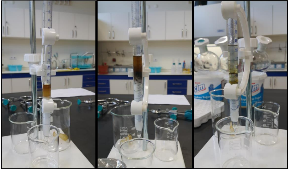
Şekil 4.34. Sediman örneklerinin clean-up aşaması görselleri
