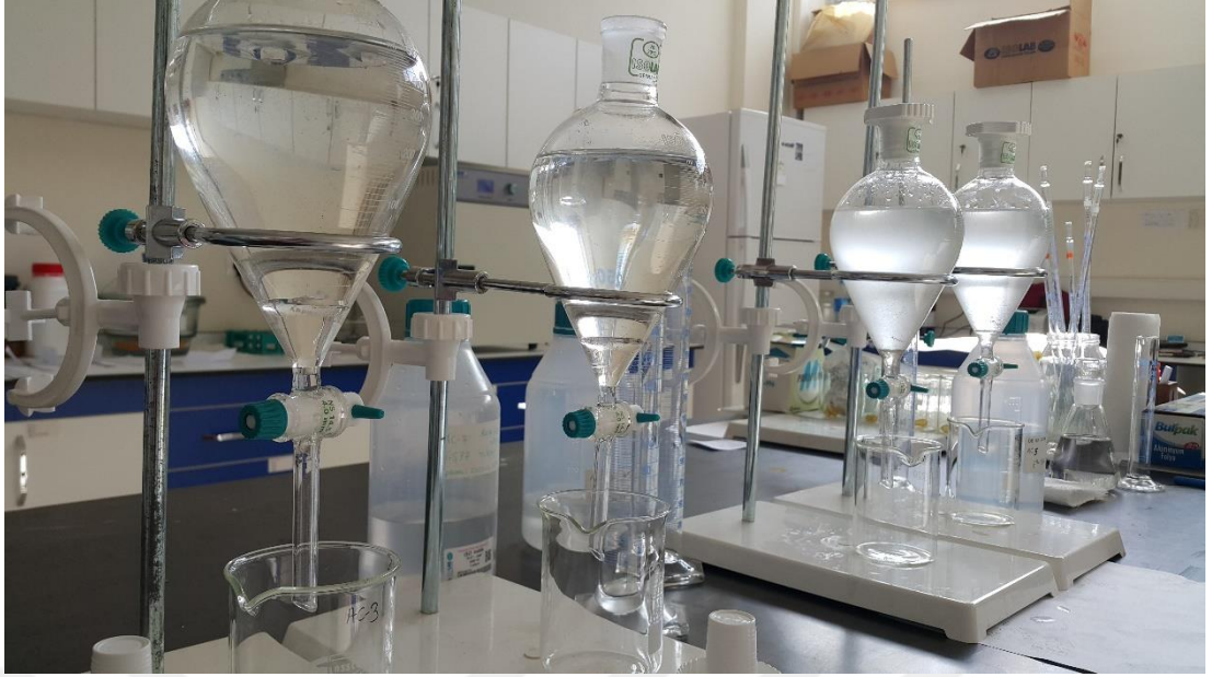
Şekil 4.38. PAH örnek hazırlama sıvı-sıvıekstraksiyonu görseli
