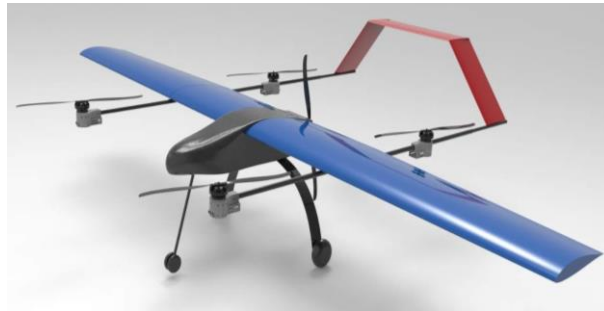
Görsel 1.7. Drone Hava Araçları | Drone, Araştırmacının dahil olduğu İHA araştırma grubunda tasarımı yapılan ve 2017 yılı çalışmasından alınan görüntüdür.
