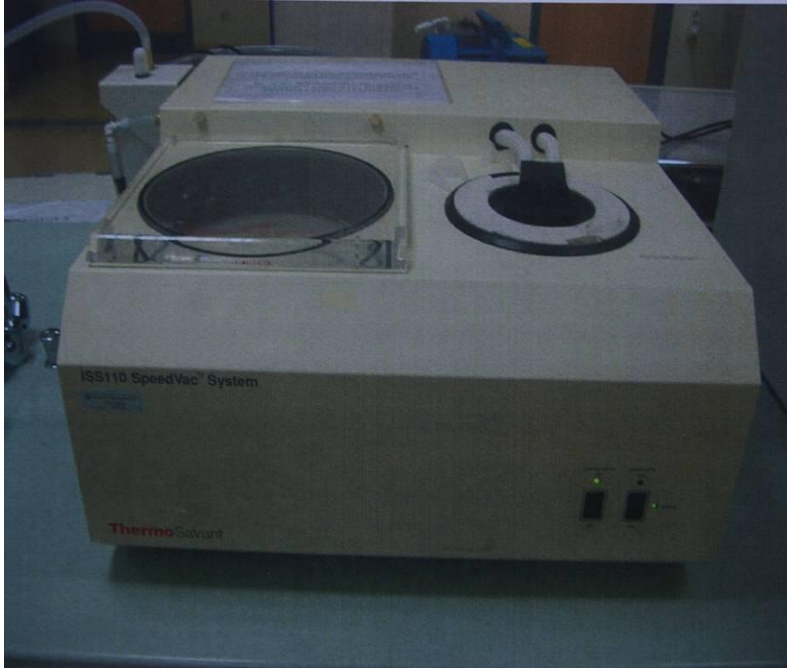
Şekil 3.4. Speed VAC Cihazı: Ekstraksiyon sıvılarının uçurulması için kullanılan cihaz.
