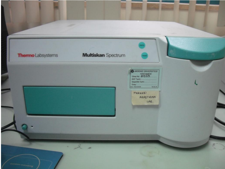
Şekil 3.6. EIA yönteminin yapılışı. Thermo Labssystem Multiskan Spectrum (Spektrofotometri- VIP, SP, CGRP ölçümleri).
