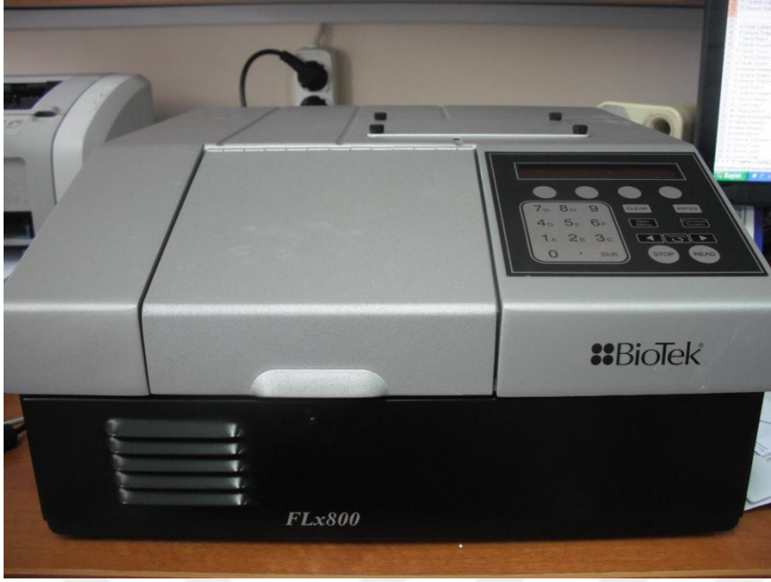
Şekil 3.7. BioTek FLx800 Fluorescence (Neprilisin ve Alfa secretase fluorometric ölçüm).
