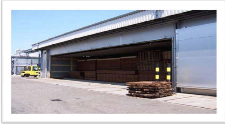
Şekil 1.7. Isıl işlem esnasında kerestenin ön kurutma, kurutma ve kondüsyonlama işlemini gerçekleştiren endüstriyel fırın (Boonstra 2008).
