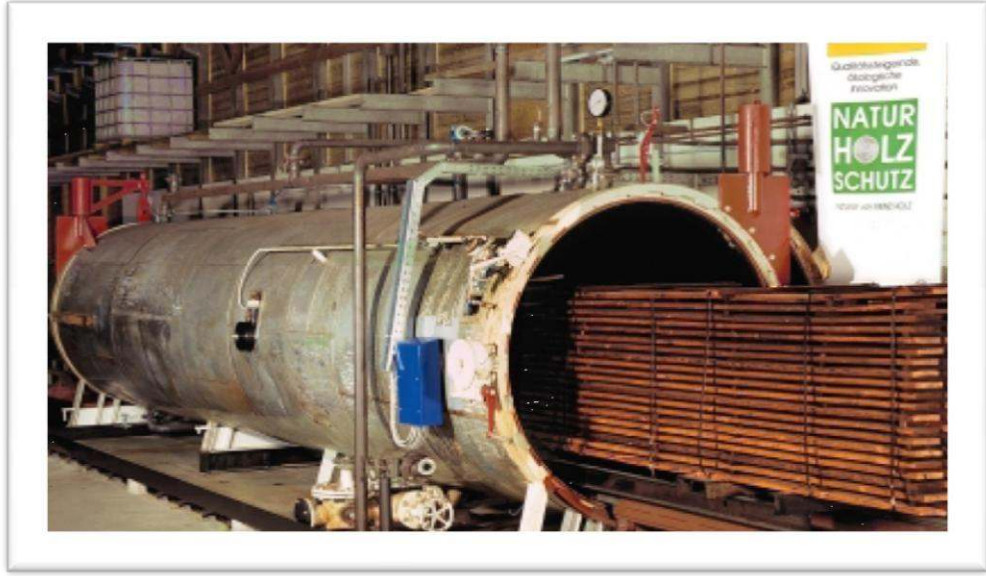
Şekil 1.12. Sıcak yağ uygulaması gerçekleştiren ısıl işlem tankı (Rapp and Sailer 2000).
