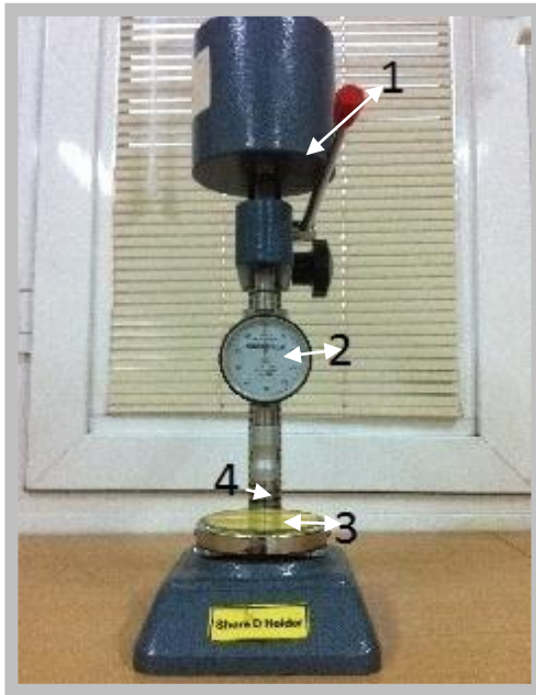
Şekil 2.3. Sertlik ölçme cihazı (Shoremetre - D).
