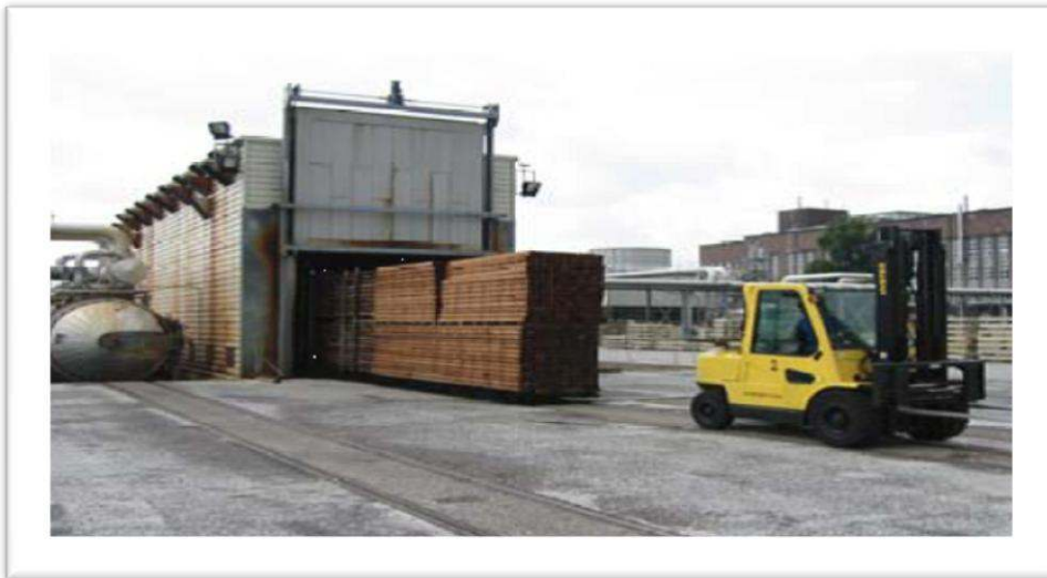
Şekil 1.8. Denkleştirme aşaması için kullanılan endüstriyel fırın (Boonstra 2008).
