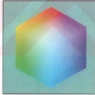
Şekil 2.4 RGB renk uzayının küp şeklindeki yapısı
