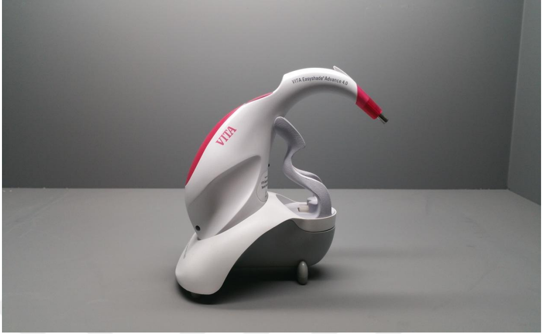
Şekil 25. Spektrofotometre cihazı (Vita Easysshade Advance 4.0, Vita Zahnfabrik, Bad Säckingen, Almanya)
