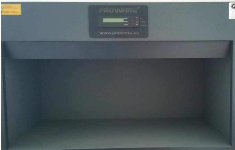
Şekil 22. Işık kabini (Prowhite K002)
