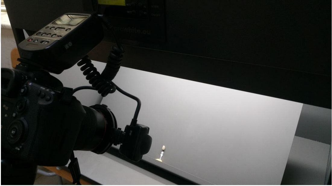
Şekil 29. Fotoğraf makinesinin tripod üzerinde 45 0 açığa ayarlanması
