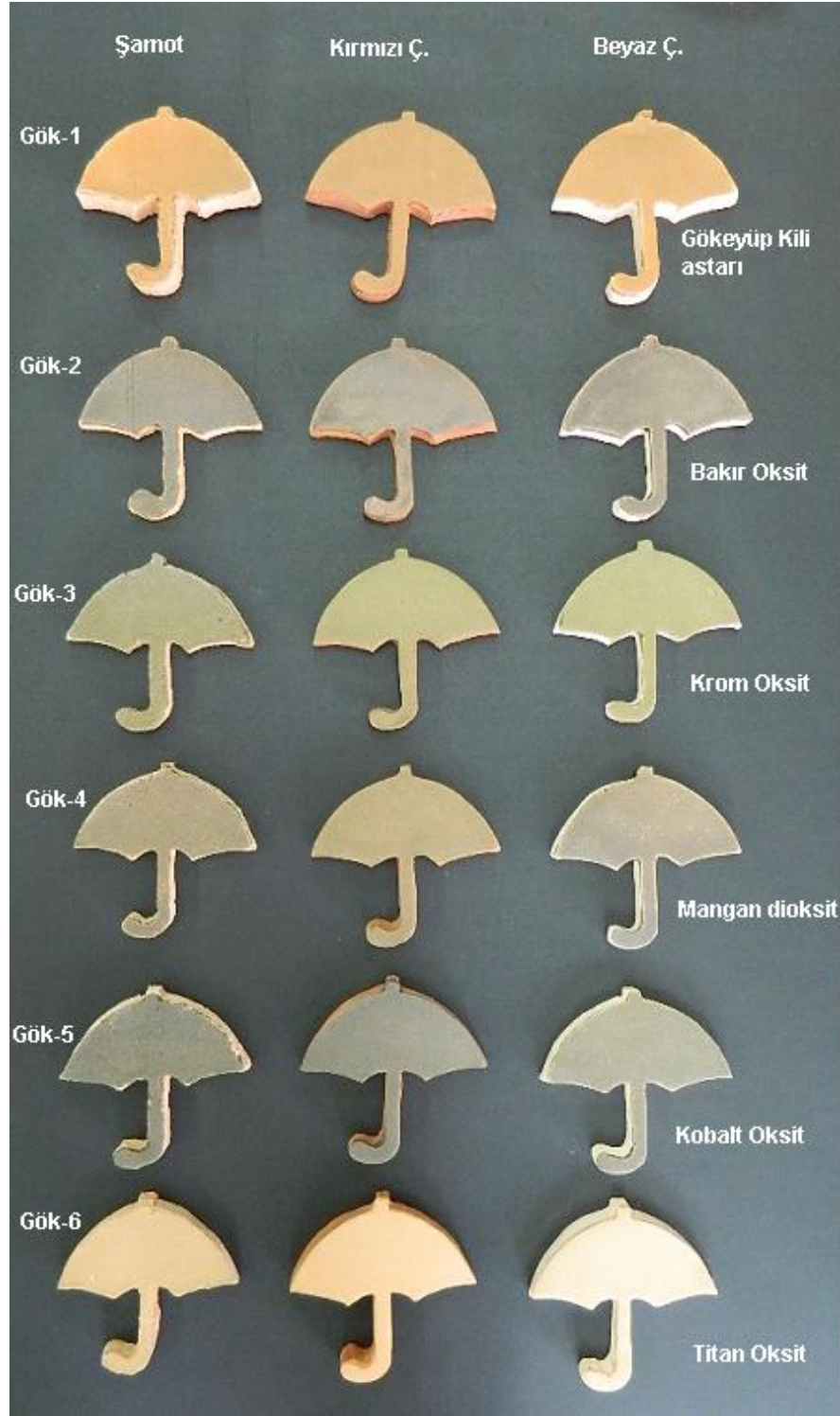
Resim 52: Gökeyüp Kili astarının metal oksitlerle renklendirilmesi
