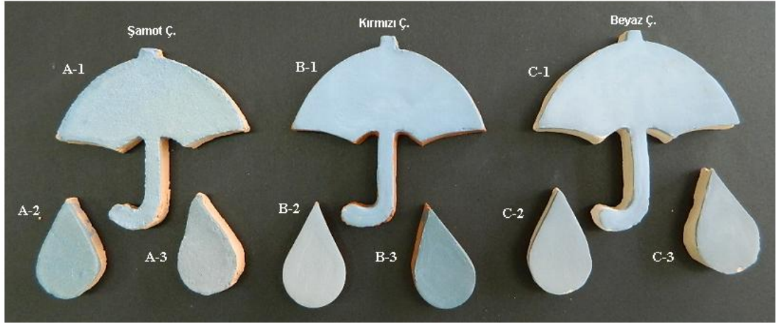
Resim 37: Söğüt Seramik vakum pres çamuru astarı ile CoO (Kobalt Oksit) Denemeleri
