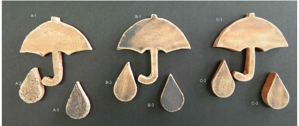
Resim 26: Çanakkale Çamur Astarına CuO (Bakır Oksit) ile renklendirilmesi
