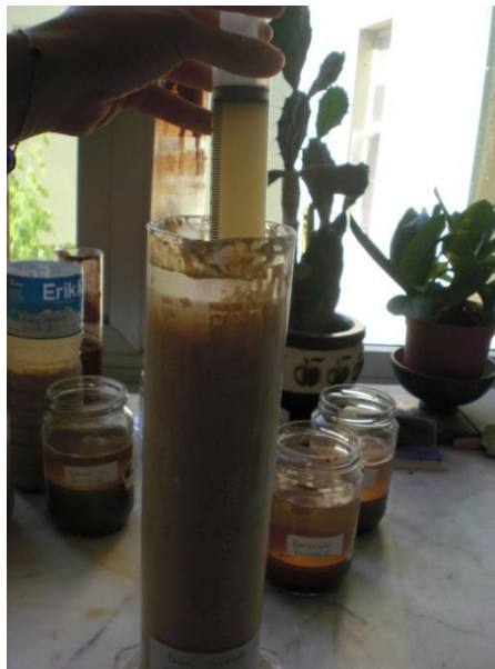
Resim 22: Mezür içindeki karışımdan bulanık ayrılmış su miktarının şırınga ile çekilmesi
