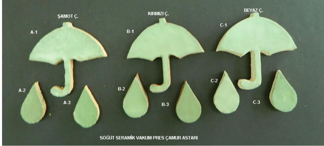
Resim 39: Söğüt Seramik vakum pres çamuruyla hazırlanan astarın Cr_2O_3 (Krom Oksit) ile renklendirilmesi
