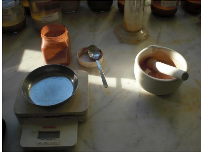
Resim 23: Renklendiricilerin tartımı ve Havan içinde öğütülmesi
