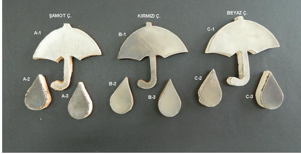
Resim 40:Söğüt Seramik vakum pres çamuruyla hazırlanan astarın MnO 2 (Manganoksit) ile renklendirilmesi
