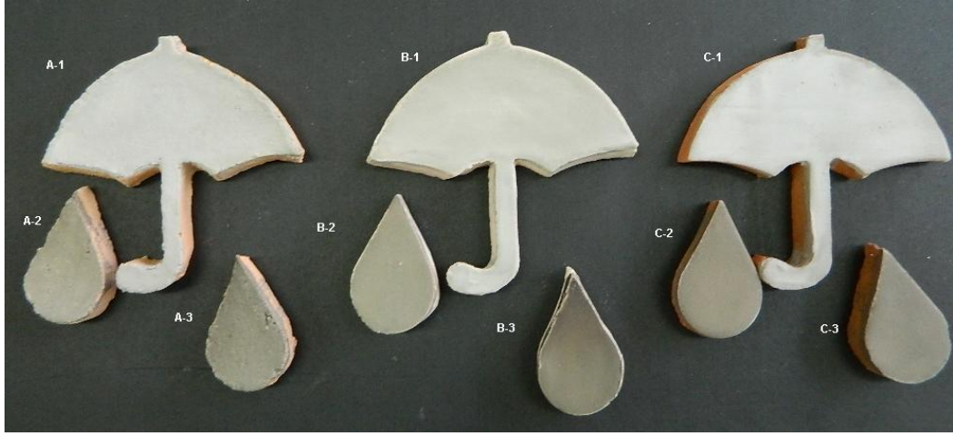
Resim 28: Çanakkale Çamuru Astarı ile MnO_2 (Manganoksit) Denemeleri.
