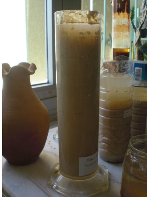
Resim 21: Çanakkale Seramik çamurunun su ile karışım halde mezür içinde dinlendirilmesi
