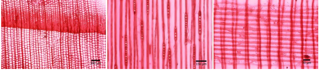
Şekil 4.32 : Merdiven basamağı örneğinin enine, teğet ve radyal kesitlerinin mikroskobik görüntüsü.
